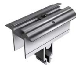
Mittelklemmen ohne Erdungspin für Rahmenhöhe 28 mm – 45 mm
